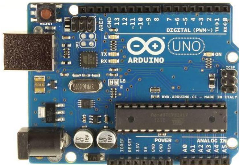
Arduino è una piattaforma hardware e software open-source con cui realizzare dispositivi digitali in grado di interagire con il mondo esterno attraverso sensori (ad esempio una fotocellula)
